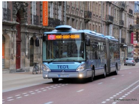
Abbildung 10: Induktive Spurführung: Phileas von APTS in Eindhoven (Testlauf) / optische Spurführung: CiVis von Irisbus in Rouen (Testlauf)
