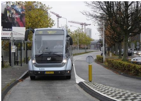
Abbildung 10: Induktive Spurführung: Phileas von APTS in Eindhoven (Testlauf) / optische Spurführung: CiVis von Irisbus in Rouen (Testlauf)
