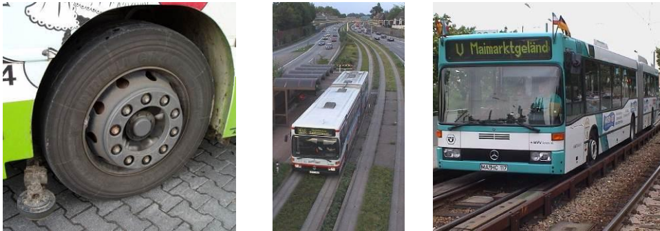
Abbildung 8: Spurführungsrolle / Spurbussystem in Essen / Spurbussystem in Mannheim
