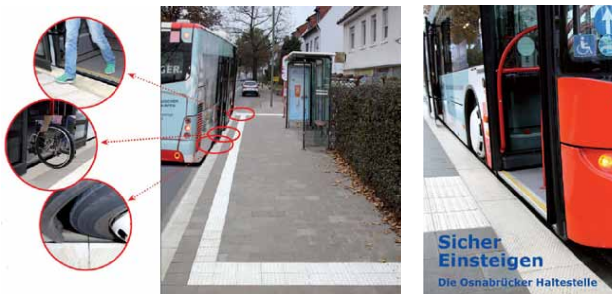
Abb. 3-8: Komponenten des neuen Haltestellensystem und Titelbild Folder
